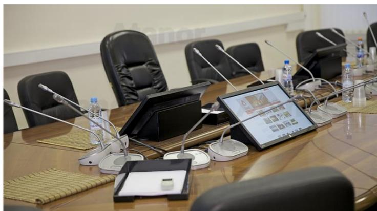
Для более комфортной работы с контентом во время сеанса видеоконференцсвязи, рядом с микрофонами установлены дополнительно пять мониторов Hewlett Packard. Дисплеи смонтированы на специальных подставках, разработанных российским производителем AV Production для конференц-залов. С одной
