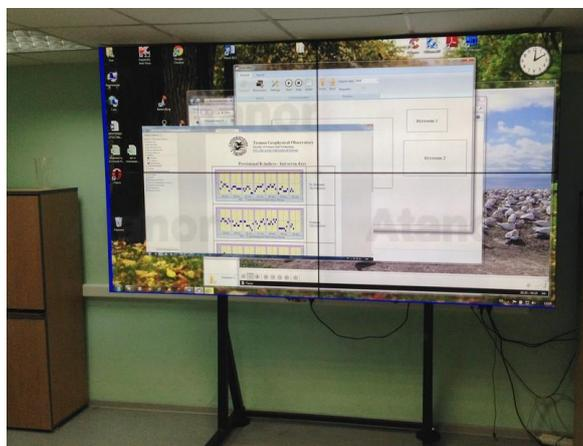
«Атанор» осуществил поставку оборудования и технологическое консультирование по установке комплекса для диспетчерской ФГБУ "Мурманское управление по гидрометеорологии и мониторингу окружающей среды". Под руководством инженеров «Атанора» была установлена видеостена и видеосервер (контроллер видеостены) для работы с метеорологическими данными.
