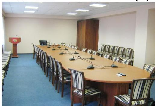
Особенность проекта в том, что один микрофонный пульт рассчитан на трех делегатов, которые по мере необходимости могут перемещать его по столу. Дополнительную свободу изменения позиции придает «гусиная шея»: это гибкая ножка микрофона с самофиксирующимся положением, которая позволяет легко менять его направленность по отношению к спикеру.
