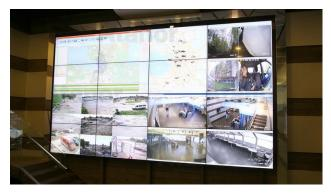
Любой источник может быть растянут на всю видеостену или размещен на любой части видеостены. Размеры окон-источников можно изменять при помощи курсора мышки. Окна могут накладываться одно на другое как слои, любое окно можно делать верхним слоем.
