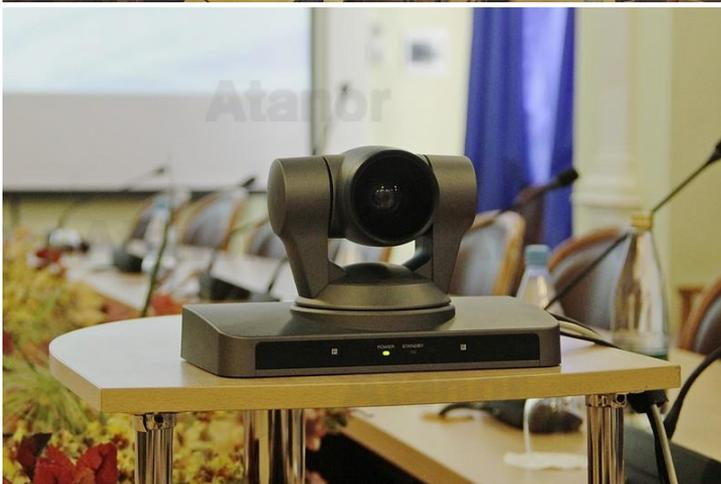
Нужно отметить, что в этом проекте в корпоративный стандарт вошло оборудование для видеоконференцсвязи и интегрированная система селекторной телефонной связи. Основной канал связи для видеоконференции организован по протоколу IP. Но также была задействована абонентская проводная линия и налажен запасной канал по протоколу ISDN — на случай если у провайдера будут перебои с интернетом.
