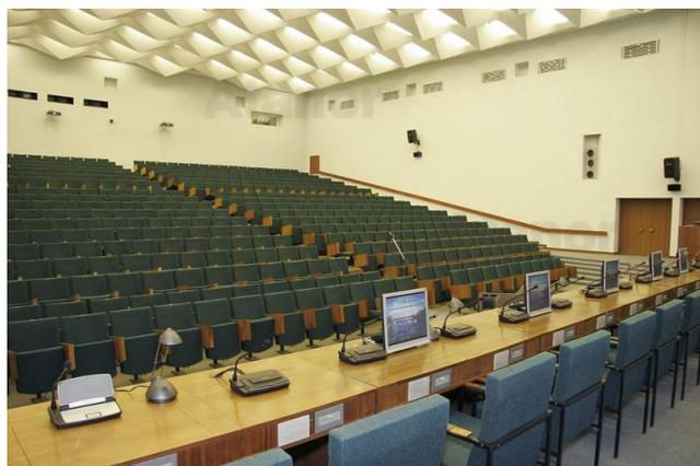
Стол президиума оснащен конференц-системой и мониторами, на которые дублируется мультимедиа, отображаемое на большом 10-метровом проекционном экране с помощью проектора Panasonic. На экраны выводится контент, который необходим докладчику – презентации, видеоматериалы – либо транслируется видео с камер, установленных в зале.
